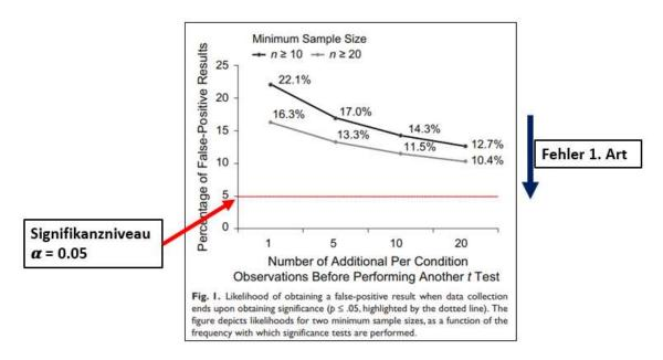
Abbildung 9: Die Reduzierung des Fehler 1.Arts bei zusätzlicher Beobachtung
